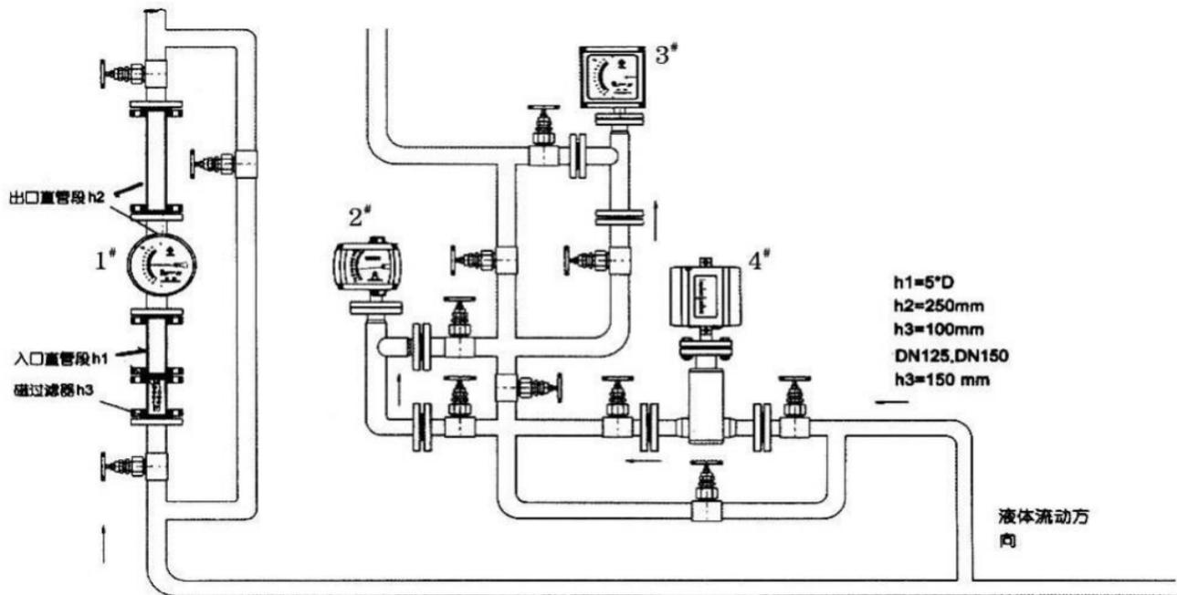
示意圖： 1. 下進上出 (標準型)    2. 側進側出    3. 底進側出    4. 右進左出 (水平型)
